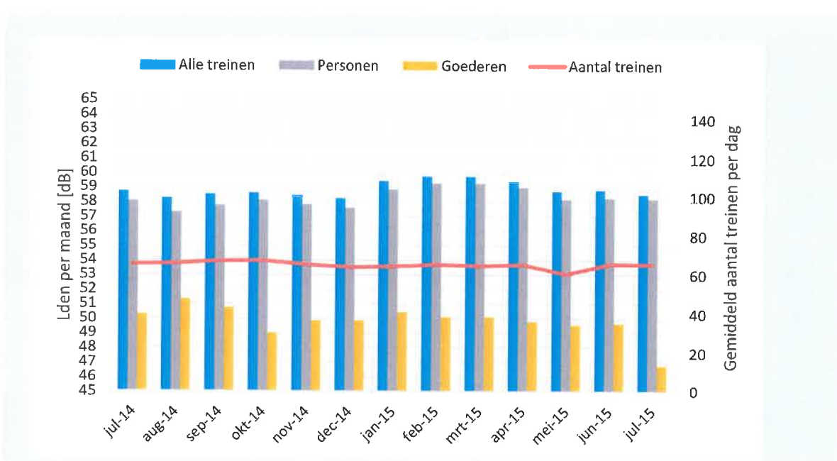
figuur 3: verloop van L_{den} waarden gedurende de meetperiode, voor jun 2014 en juli 2015 is de meetperiode omgerekend naar een hele maand.
